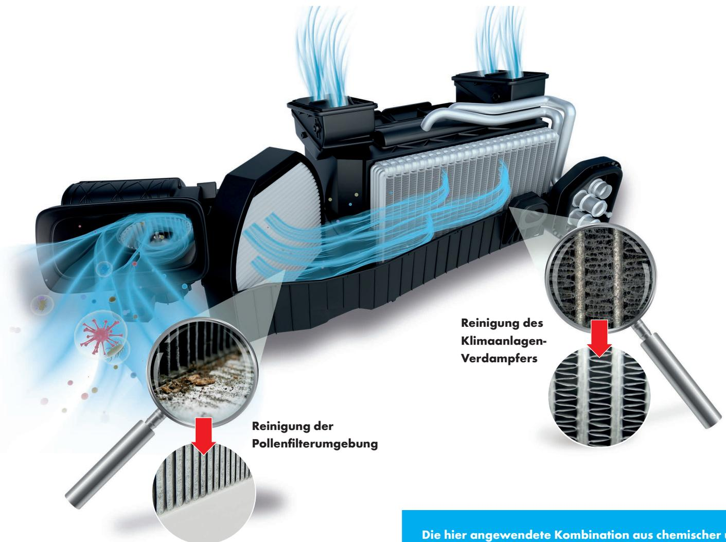
Die hier angewendete Kombination aus chemischer und mechanischer Reinigung führt zu einer hygienisch reinen Klimaanlage und sorgt für gesunde Luft im Auto – ganz ohne Farb- und Duftstoffe.
